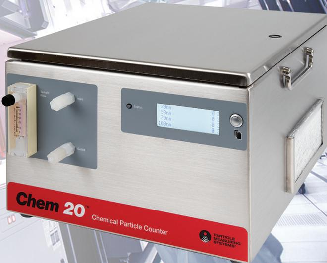
液中パーティクルカウンタ Chem20™は、最先端の電子産業向け高品位薬液に含まれる不溶性微粒子を測定するために開発された、高感度の常時モニタリング装置です。Chem20™は、最小粒径検出感度20nmを達成した、業界初の液中パーティクルカウンタであり、Ultra DI® シリーズで実績のある光学系を耐薬品設計へ進化させることにより、低偽計数で且つ優れた測定安定性を実現いたしました。
