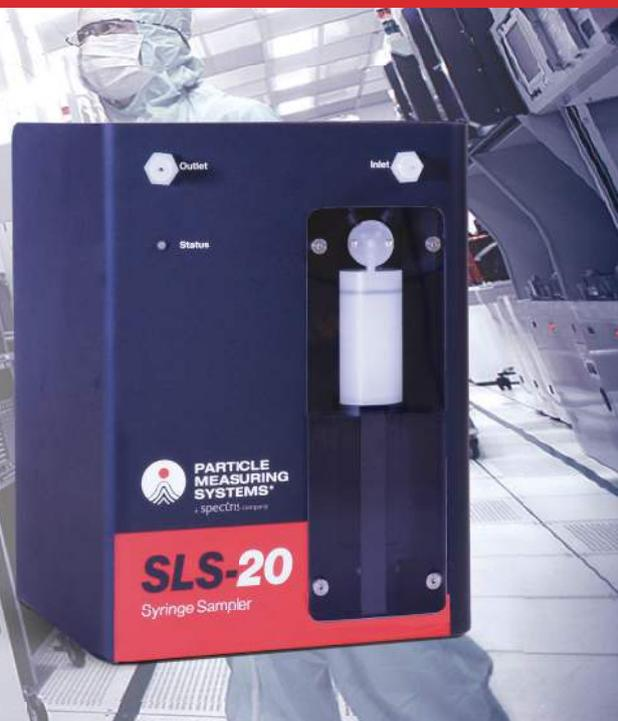
SLS-20 シリンジサンプラーは、Chem 20 液中パーティクルカウンター用のサンプリング装置です。Chem 20は高品位薬液・超純水中に浮遊する不溶性微粒子を20 nmレベルで検出する高感度のモニタリング装置です。SLS-20により、Chem 20を使用したバッチ測定が可能です。
