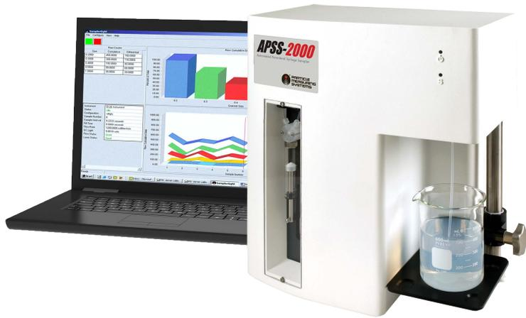
APSS-2000 は液体中に浮遊する不溶性微粒子の粒径別粒子数を自動計測する光遮蔽型微粒子自動測定システムです。日本薬局 (JP)、米国薬局方 (USP)、欧州薬局方 (EP) に定められた注射剤 (輸液剤を含む)・点眼剤・プラスチック製医薬品容器の不溶性微粒子試験に必要な不可欠な機能を備えています。製薬業界特有のバリデーション (CSV) やデータインテグリティにも対応しており、最終製品の品質保証を確実なものにします。
